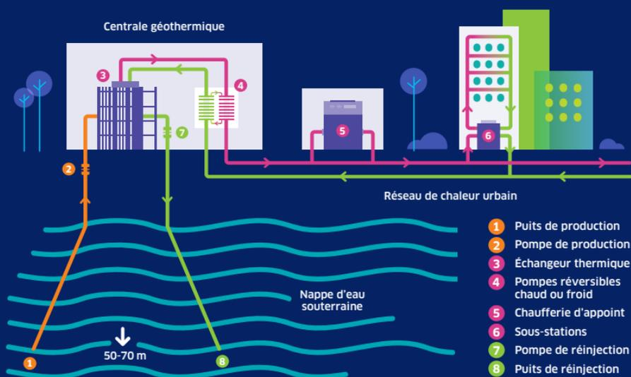
11 puits composent la géothermie du quartier Pleyel. L'eau puisée est ensuite acheminée vers la centrale géothermique.
