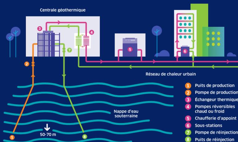
Les 3 puits producteurs extraient l'eau de la nappe. L'eau puisée est ensuite acheminée vers la centrale géothermique Pleyel.
